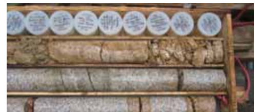
岩石樣本，即「岩芯」。 Rock samples, namely "Cores".
